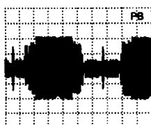
A: AC, 50 mV/Div, 5 ms/Div IC 7051 Pin 27
